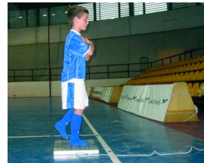
"TEST DI EQUILIBRIO EFFETTUATO TRAMITE PEDANA DI FORZA COLLEGATA A MUSCLE LAB BOSCO SYSTEM"
